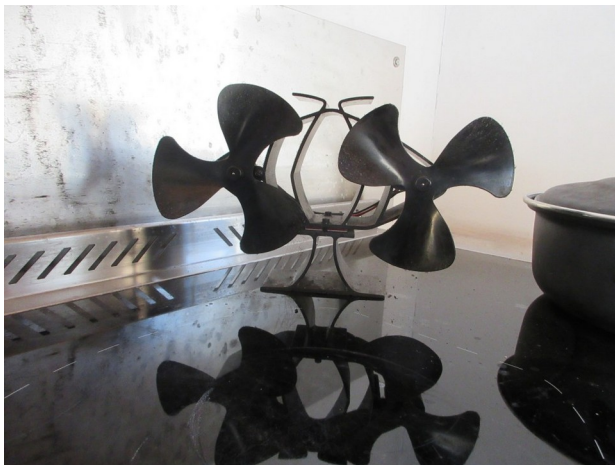
Der Lüfter mit "Peltier-Effekt"
